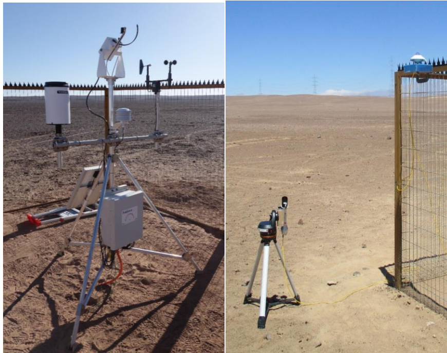
Figura 2. Sistema de medición de radiación solar tipo Rotating Shadowband Irradiometer (RSI) a la izquierda, y equipos para comparación en terreno a la derecha.
