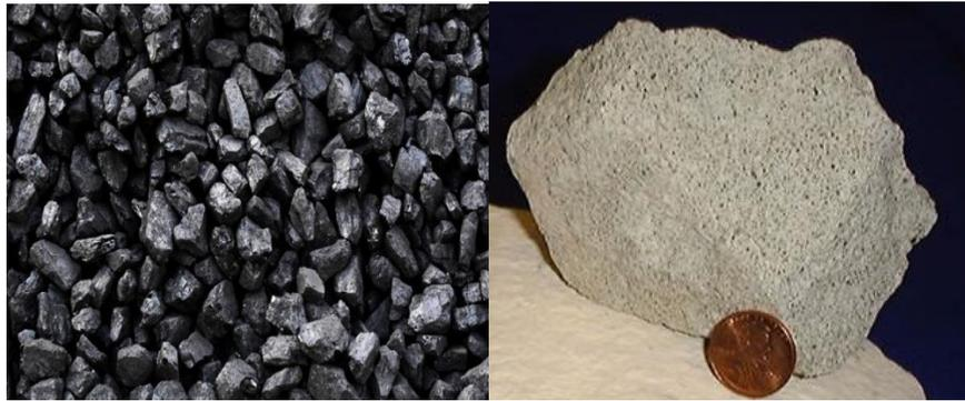
**Figura 7:** Carbón activado (izq.) y zeolita (der.)
