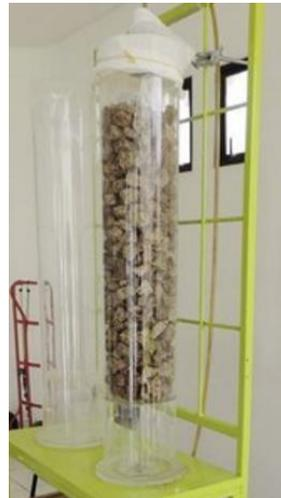
**Figura 27:** Biofiltro de piedra de lava en escala laboratorio [40]
