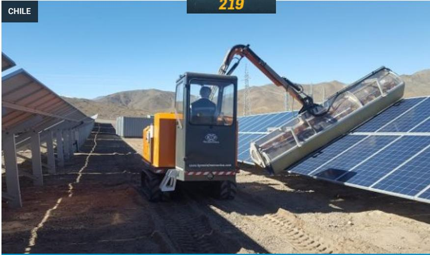
CHILE Sistema de limpieza en seco en planta solar. Foto: Gentileza Engie Laborelec Chile.
