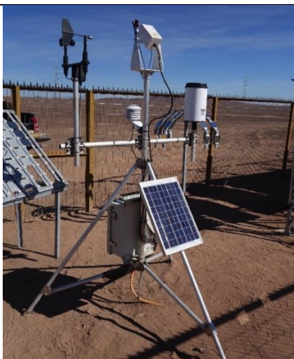
Figura 27 - Estación meteorológica autónoma en Diego de Almagro
